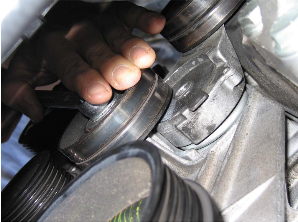
Der Riemenspanndämpfer ist jedoch ein Kapitel für sich – er ist von hinten gegen den Motorblock verschraubt. Dies bedeutet, dass zuerst das Warmluftfangblech über dem Krümmer losgeschraubt werden muss.
