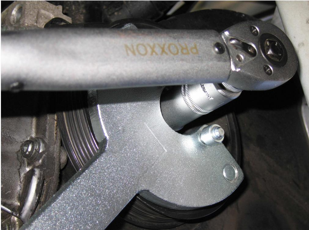
Nun kann die Riemenscheibe vorsichtig abgenommen werden. Die alte Schraube wird zur Sicherung des Zahnrades mit zwei Unterlegscheiben wieder eingeschraubt, so dass sich nun folgendes Bild ergibt:
