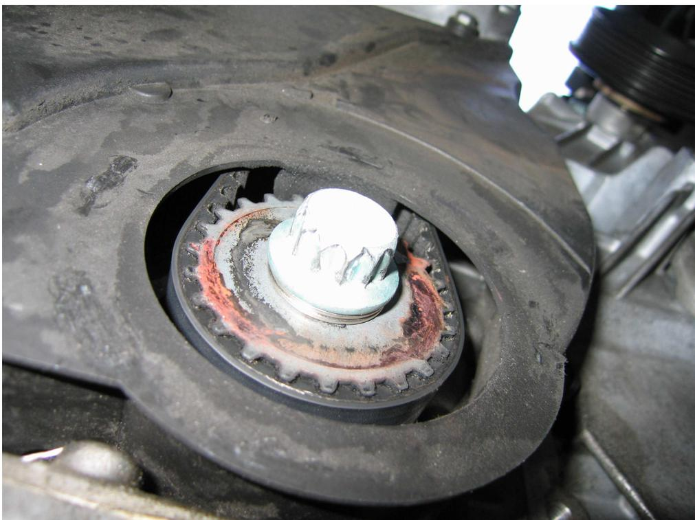
Dies ist das untere Ende des Haupttrieb-Zahnriemens – hier läuft er über das Zahnrad an der Kurbelwelle.
