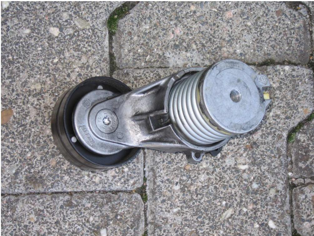
Und so sieht der Riemen­spanndämpfer im ausgebauten Zustand aus.
