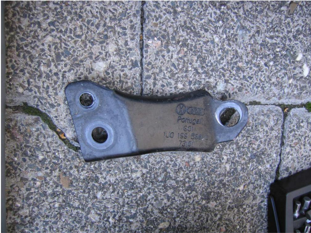
Sind alle Schrauben gelöst, hat man mitunter auch diesen Halter in der Hand. Er verbindet die Aggregatlagerung nochmals mit der Karosserie.
