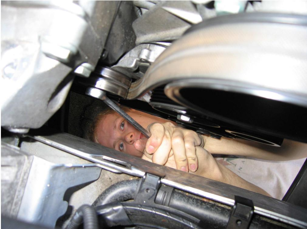
Das Spannrollendämpferelement wird mit einem passenden Ringschlüssel nach hinten (im Bild also nach links) gezogen und damit entspannt. Während, wie hier im Bild Milan2000, der Helfer die Spannrolle so hält kann der Riemen an den übrigen Rädern von einer zweiten Person abgenommen werden.
