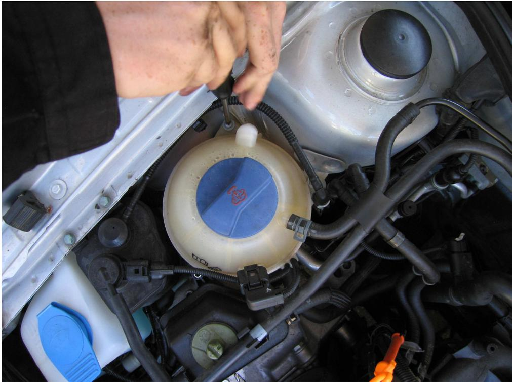
Um an alle Schrauben des Aggregathalters am Motorhalter zu erreichen, muss der Ausgleichsbehälter der Wasserkühlung losgeschraubt werden. Danach können nun die Schrauben von Aggregatlagerung / Motorhalter (blauer Pfeil), Aggregatlagerung / Karosserie (hier schon demontiert, roter Pfeil) und Halter Aggregatlagerung / Karosserie (hier unter Servobehälter, gelber Pfeil) gelöst werden.
