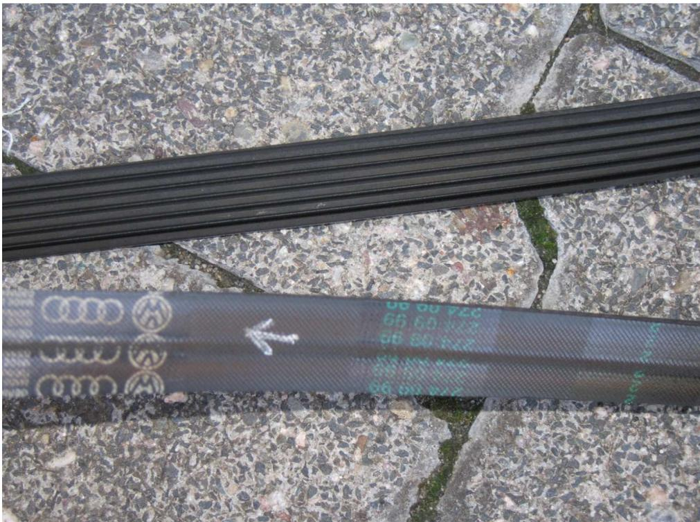
Hier im Bild zu sehen: Der weiße Pfeil mit der Laufrichtung bei ausgebautem Riemen.
