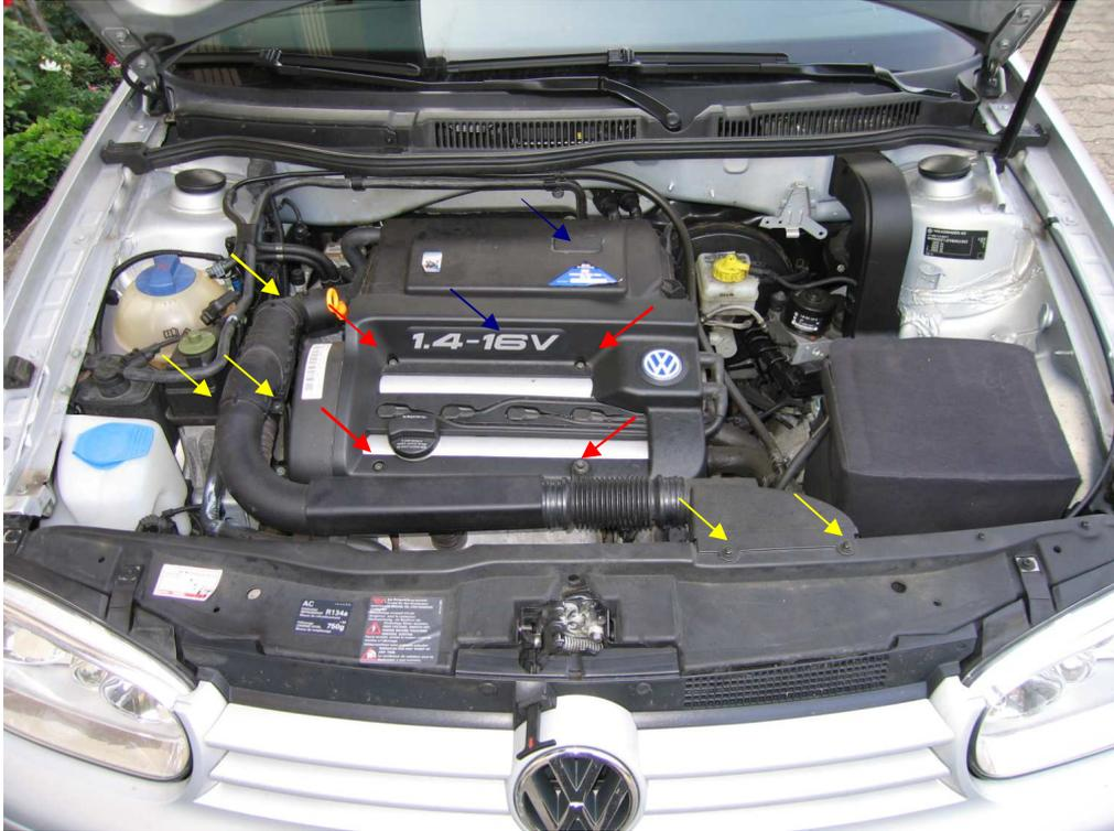
So sah der Motorraum um 9 Uhr morgens aus. Folgende Teile müssen abgeschraubt werden: die Motorabdeckung (4 Imbusschrauben, rote Pfeile), der Luftansaugkanal (bei Fahrzeugen mit Klimaanlage wie im Bild zu sehen, ohne Klima etwas kürzer – 5 Kreuzschlitzschrauben, der Schlauch kann am Warmluftauffangblech abgezogen werden, gelbe Pfeile) und der Luftfilterkasten (2 Torxschrauben, eine unter der Abdeckung, blaue Pfeile).
