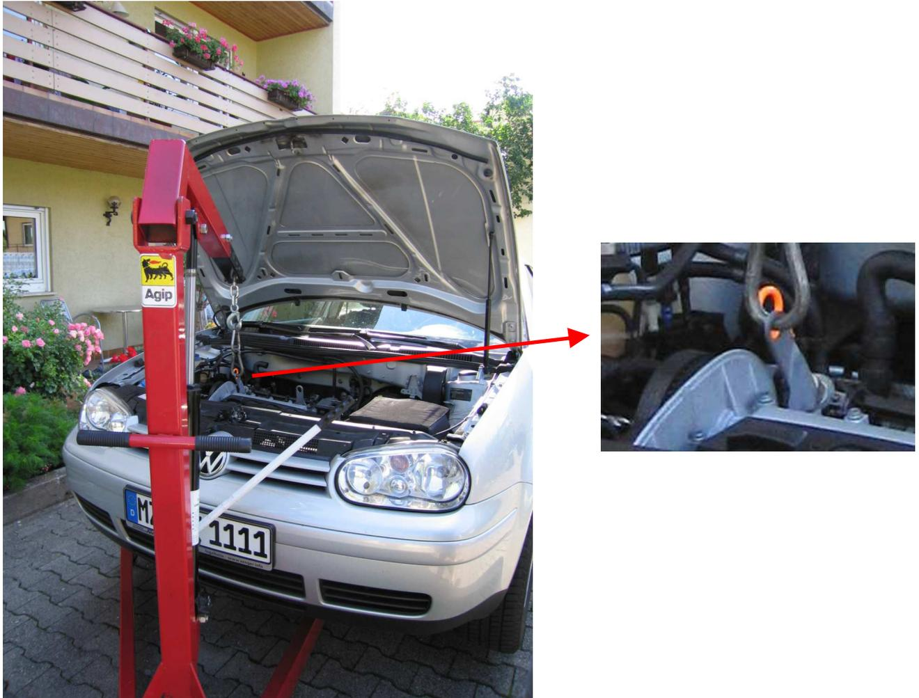
Möglichkeiten, den Motor aufzuhängen, gibt es viele. Entweder mit einer Motorbrücke, einem Motorkran (wie hier im Bild), einer Seilwinde...die Befestigungen sind ab Werk für Montagearbeiten am Motorblock vorhanden und werden dann natürlich auch dafür genutzt. Es reicht den Motor wie hier nur links aufzuhängen, da nur das Motorlager an der linken Seite gelöst wird. Außerdem kann der Motor dann auf der linken Seite durch Absenken oder Anheben für weitere Arbeiten positioniert werden.
