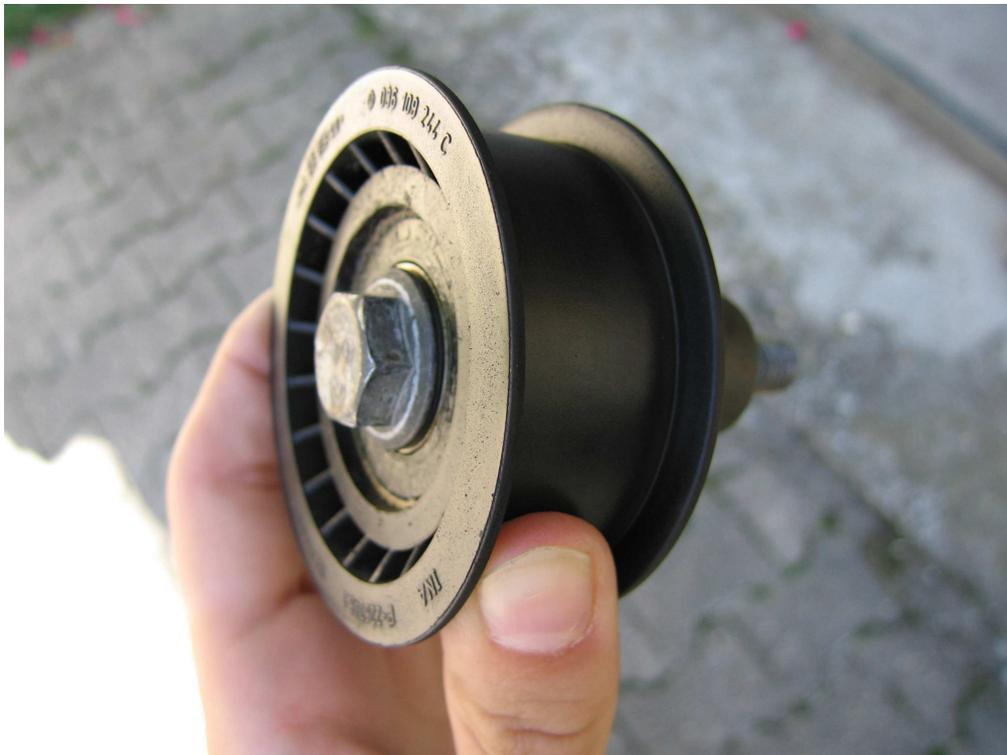
Die neue Umlenkrolle kann hier direkt montiert werden. Die Schraube wird mit 50Nm Drehmoment angezogen. Im Anschluss prüfen, ob sich die Rolle leicht drehen lässt.
