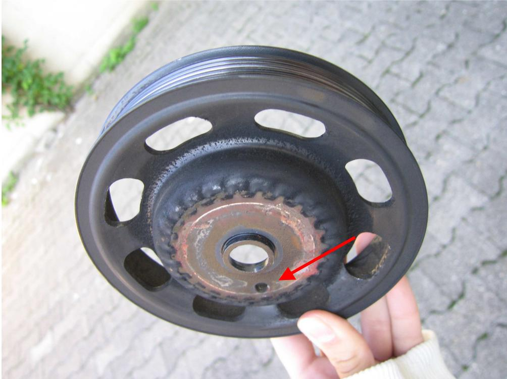
Neben den Abdrücken des Zahnrades kann man hier ein kleines Loch (roter Pfeil) erkennen. Dieses dient zur Arretierung des Keilrippenriemenrades auf dem Zahnrad der Kurbelwelle. Dies kann man sich schon mal für den Einbau merken, da damit die richtige Position automatisch erreicht wird.
