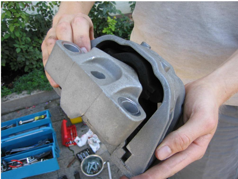
Und das ist die Aggregathalterung – gut zu erkennen der dicke, schwarze Gummipuffer im Inneren.
