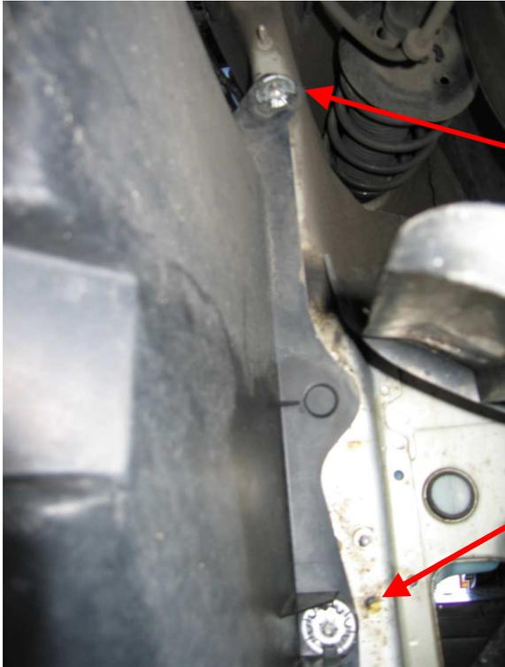
Dies sind die Klemmscheiben – sie werden beim Ausbau normalerweise „zerstört“. Zusätzlich ist noch eine Torx Schraube (nicht im Bild) zu lösen, dann kann die Dämpfungswanne abgezogen werden.
